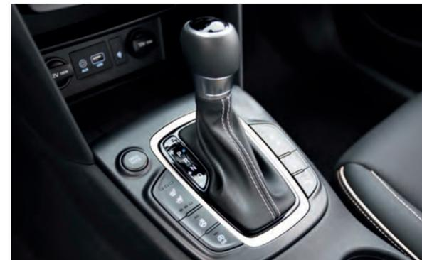
**Hộp số tự động 6 cấp hoặc 7 cấp ly hợp kép**
